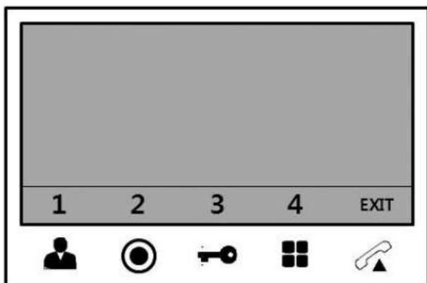
На дисплее отобразятся цифры от 1 до 4, обозначающие номера портов. Изображение от соответствующей камеры, подключенной к каждому из портов, будет отображаться при нажатии на соответствующую цифру, обозначающую номер порта.
