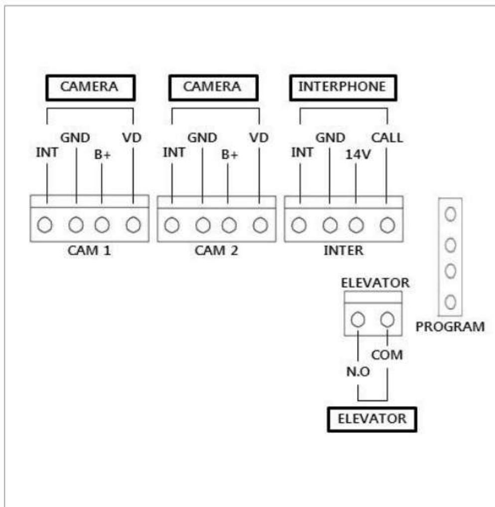
※ Если вы подключаете монитор к системе MODUM, необходимо подключить к порту «CAMERA2» и поэтажному распределителю (обратитесь к руководству пользователя поэтажного распределителя).
